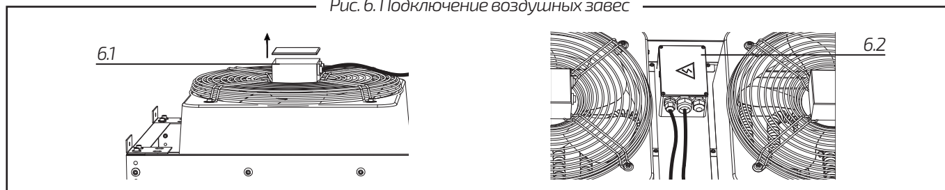
Рис. 6. Подключение воздушных занавесок
